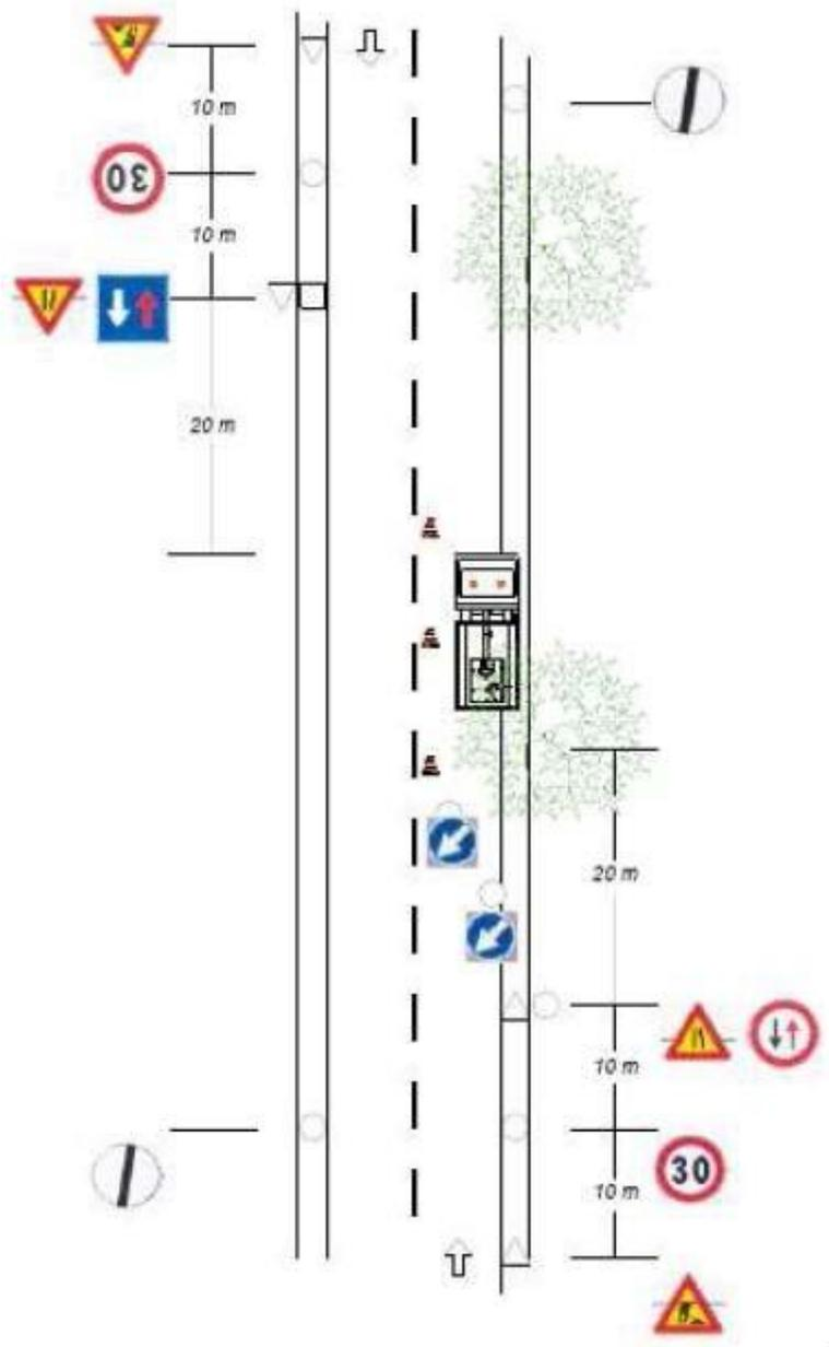
INSTALLAZIONE DI CANTIERE TEMPORANEO – CANTIERE URBANO A MARGINE DELLA CARREGGIATA A DOPPIO SENSO DI MARCIA CON MOVIERI E CON ARREGGIATA RESIDUA < 5,6 METRI
