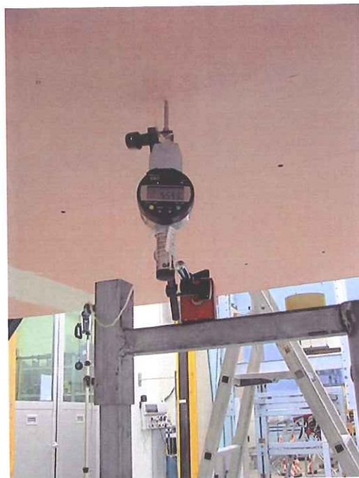
Fotografie del comparatore digitale durante la prova.
